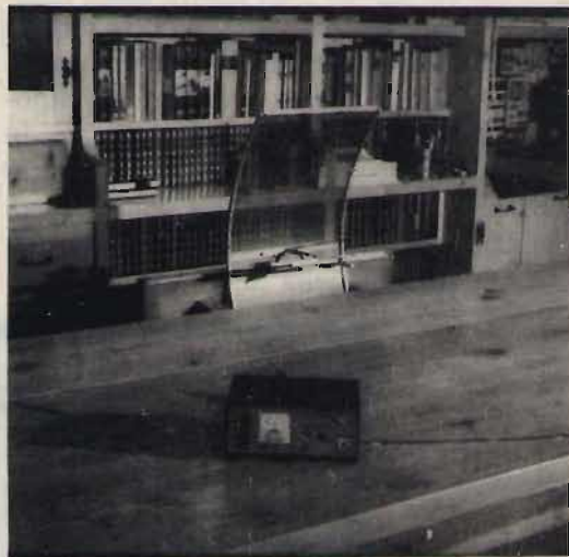
foto 7 Per determinare approssimativamente il "lobo di irradiazione" dell'antenna, potremo utilmente impiegare un misuratore di intensità di campo, tracciando su un vasto piano isolante un semicerchio intorno al radiatore stesso. Ciò va fatto sia per la polarizzazione orizzontale che per quella verticale.
